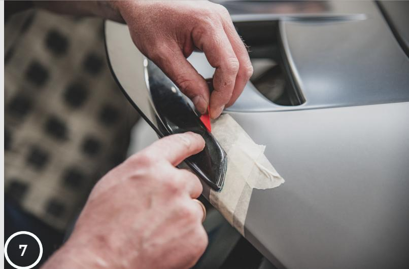
8. Entfernen Sie langsam den Rest der Folie vom doppelseitigen Montageband, halten Sie den CAP Spoiler an der markierten Montagestelle fest und üben Sie Druck aus (bitten Sie jemanden um Hilfe, um zu verhindern, dass sich das Teil bewegt).
