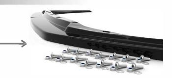
Halten Sie den Frontspoiler vor dem Einbau immer an die Stoßstange an, um sicherzustellen, dass er passt.
