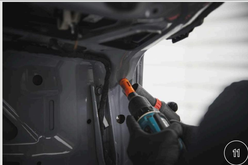
11. Vergrößern Sie die übrigen Löcher auf der Innenseite des Kofferraumdeckels ebenfalls mit einer Lochsäge.
