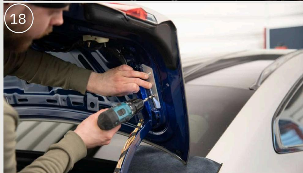
16. Das Schutzklebeband entfernen und die gebohrten Löcher überprüfen.
