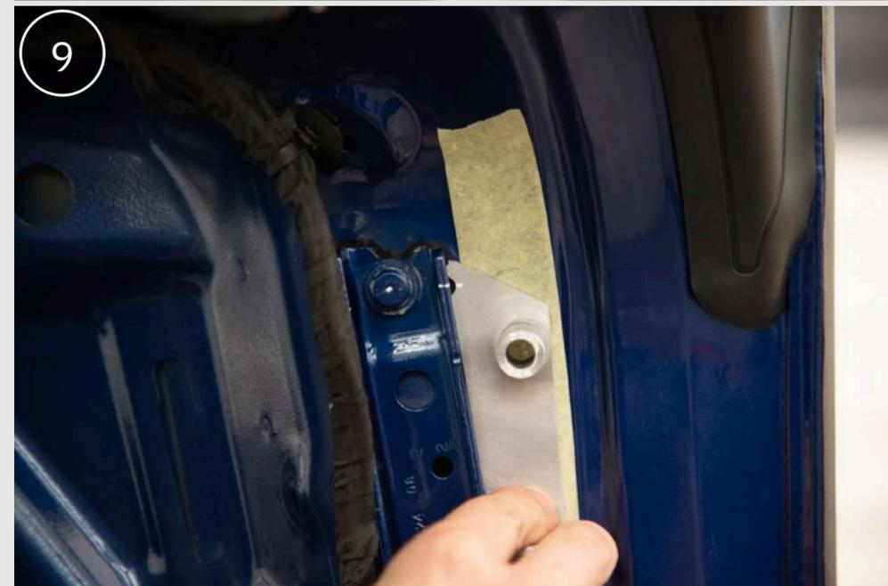
8. Die Mitte der Aussparung an der Hülsenhalterung markieren.
