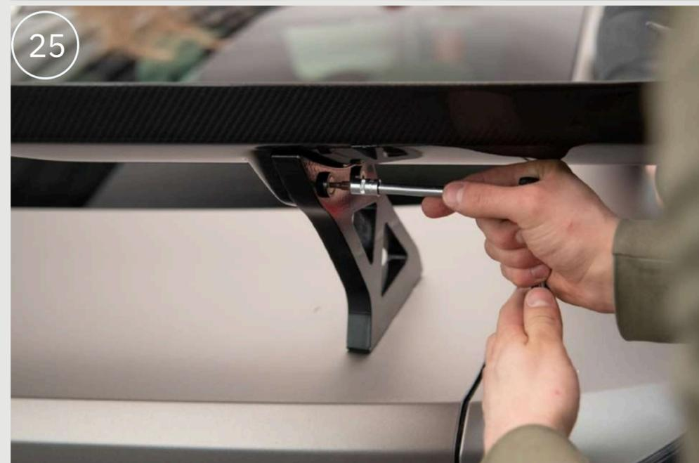
24. Den Spoiler leicht an den Halterungen festschrauben und sicherstellen, dass er gleichmäßig sitzt.
