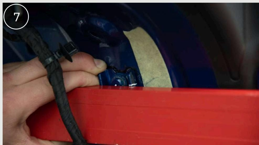
4. Die Mitte der Befestigungsschraube der Heckklappe markieren.
