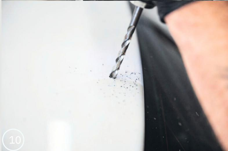
9. Vergrößern Sie die Löcher an der Innenseite des Kofferraumdeckels, um Zugang zur äußersten Schicht des Dachblechs des Kofferraumdeckels zu erhalten.
