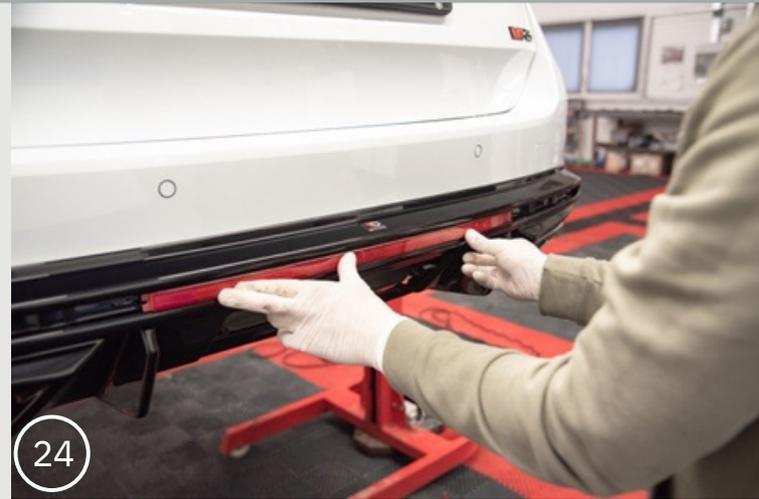
23. Entfernen Sie den Rest des Schutzbandes von der Stoßstange und drücken Sie die Stoßstange an den Stoßfänger.
