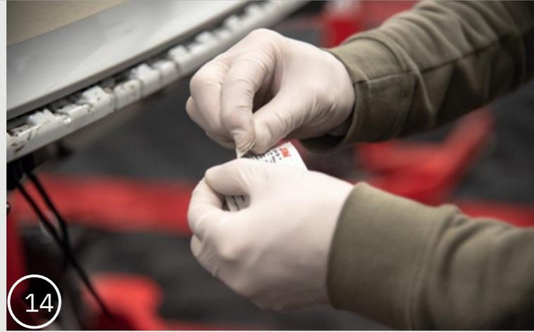
13. Ziehe die kleinen Schutzstreifen des Klebebands von der Heckschürze ab.
